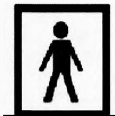
Прибор с рабочей частью типа BF
