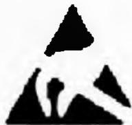
Этот символ указывает, что датчик содержит электростатически-чувствительные электронные элементы, которые чувствительны к повреждениям электростатическим разрядом.
